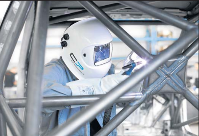
Höchste technische Präzision für die Sicherheit - hier bei der Fertigung eines Sicherheitskäfigs bei »CP Autosport«.
