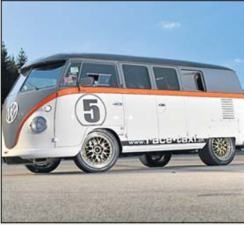
Dieser VW-T1 ist ein Wolf im Schafspelz und wird auch am Sonntag auf dem Bilster Berg gezeigt: Die gesamte Technik des Fahrzeugs stammt aus einem Porsche 993 Bi-Turbo. Das Renntaxi hat 500 PS und eine Spitzengeschwindigkeit von 230 Stundenkilometern. Sechs Jahre hat Fred Bernhard aus der Schweiz an dem Wagen gebaut. Er hatte das Ziel, mit diesem Projekt etwas Einmaliges zu schaffen Foto: J. Bürgermeister
